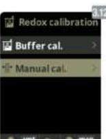
3.12 Manual calibration (ручная калибровка): Позволяет регулировать датчики на 1 пункт (без буферов) - рекомендуется только для регулировки небольшого отклонение в показаниях.
