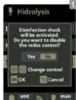
1.2 Shock: Непрерывная фильтрация в теч. 24 часов. Автоматический возврат к запрограммированному режиму инфильтрации.
