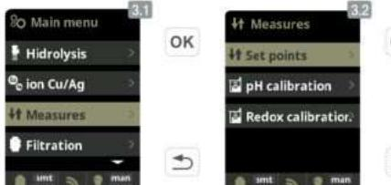
3.9 Calibration of the redox probe (калибровка датчика Redox): рекомендуем проводить каждые 2 месяца
