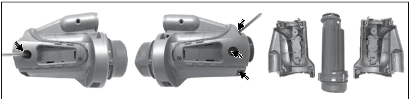
6) Извлеките аккумулятор и найдите коннектор проводов. Нажмите на зажим коннектора и отсоедините его. ПРИМЕЧАНИЕ: Сразу же обмотайте коннектор аккумулятора изоляционной лентой, чтобы избежать короткого замыкания, вызванного контактом обеих клемм.
