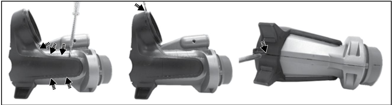
5) Открутите винты спереди и сбоку, как показано на рисунке. Снимите половинки корпуса, чтобы открыть рабочий блок.
