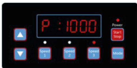
Рисунок 4.9, Дисплей энергопотребления, Скорость 3
