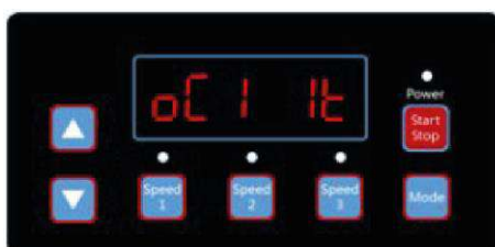
Рисунок 4.25, Автовосстановление, детали ошибки OC1, время ошибки 1
