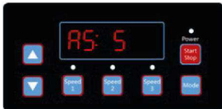
Рисунок 4.27, Обратный отсчет автозапуска, осталось 5 секунд
