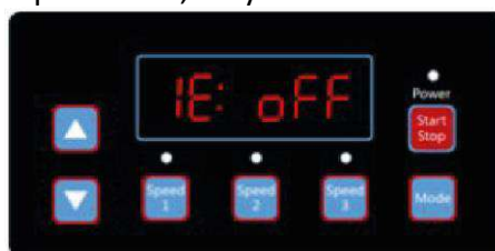
Рисунок 4.15, График работы 1 Вкл/Выкл, по умолчанию Выкл.
