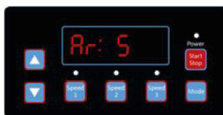
Рисунок 4.26, Обратный отсчет автовосстановления, осталось 5 секунд
