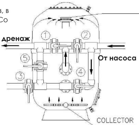
При использовании воздуха для выполнения обратной промывки, используйте адекватный поток воздуха (рекомендуемые нормы 60 м<sup>3</sup> / ч / м<sup>2</sup>). Никогда не используйте компрессор, так как это может привести к серьезному повреждению фильтра. Продувку фильтра осуществлять с помощью вентилятора, гарантируя, что внутреннее давление в фильтре при обратной промывки не превышает 1 бар.
