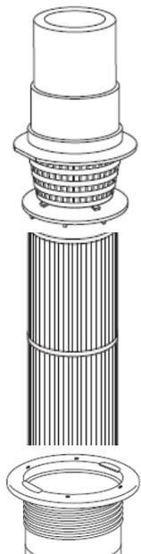
Чтобы удалить пятна, например от лосьонов, промойте картридж теплой водой с добавлением рекомендованного дилером дезинфицирующего средства. Для удаления оставшихся частиц грязи можно использовать щетку.
